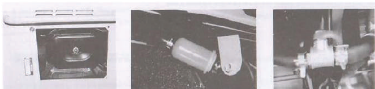
Figura 9 – Schimbarea filtrului de aer
