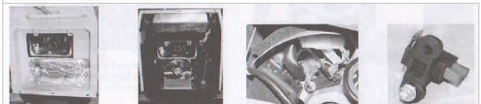
4. Rimuovere il pannello dall'estremità. 5. Il gruppo spazzole è visibile. 6. Cercare le spazzole di carbone. 7. Sostituire le spazzole di carbone.
